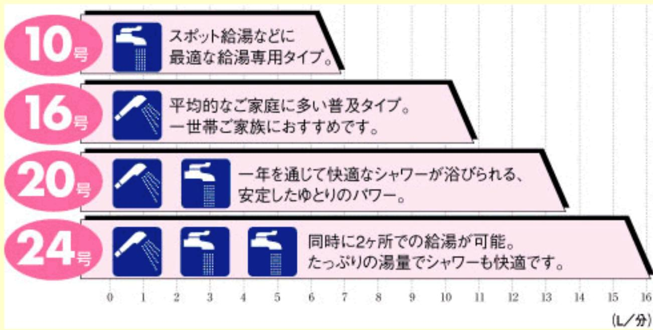
水温+25℃のお湯を1分間に何リットル出せるかを示すのが号数です。例えば、水温17℃の時に+25℃である42℃のお湯を1分間に24リットル出せるのが24号となります。冬は水温が下がるので、夏に比べてお湯の出る量が少なくなります。
